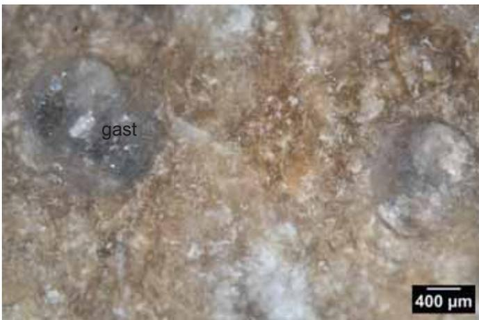
Photo 3 – Échantillon géologique 66-2, texture *packstone* à débris de characées et de gastropodes à remplissage de macroquartz.
