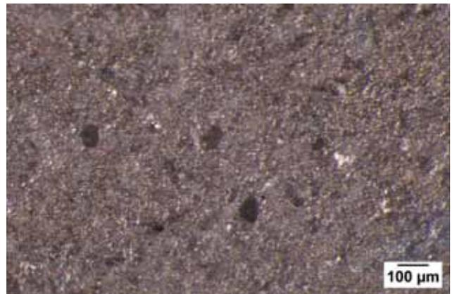
Photo 4 – G7-05 (11), matrice cryptocristalline à grains de quartz.
