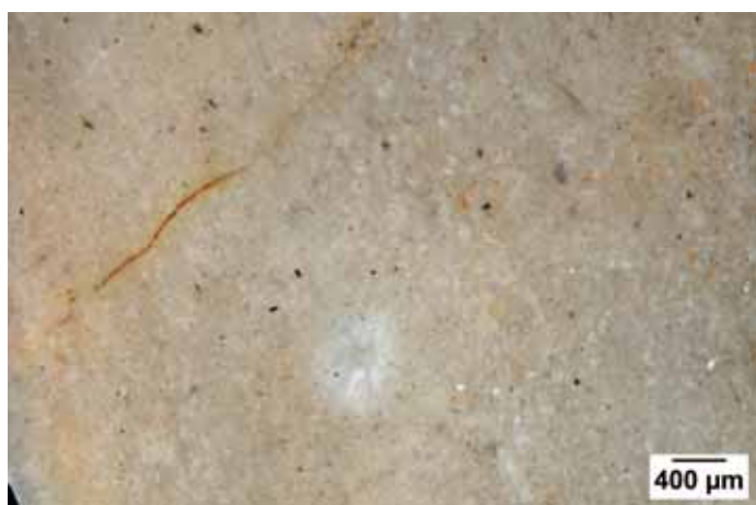
Photo 1 – Echantillon géologique n° 13, texture mudstone à micro-débris indéterminés.
