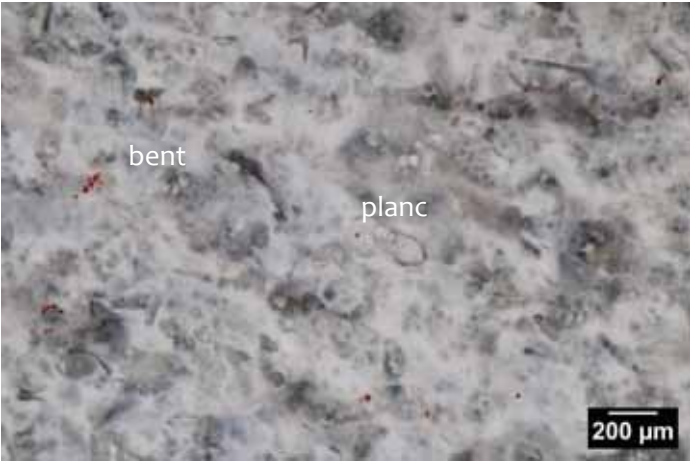
Photo 3 – Echantillon géologique n° 18, texture packstone riche en foraminifères benthiques et planctoniques et divers débris.
