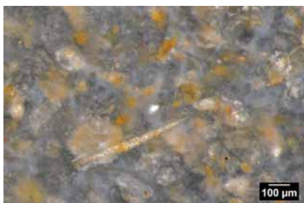
Photo 5 – Echantillon géologique n° 19. Texture packstone à éléments indéterminés.
