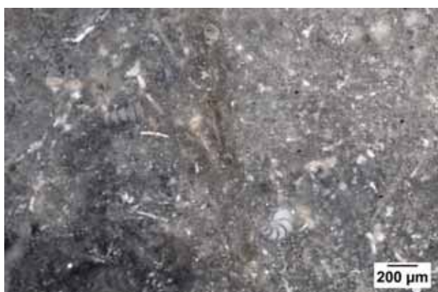
Photo 3 – Echantillon géologique n° 24-2, texture wackestone à foraminifères benthique et spicules.
