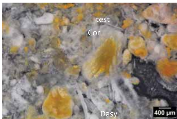
Photo 4 – Echantillon géologique n° 8, texture packstone à dasycladacées, débris coralliens et tests.
