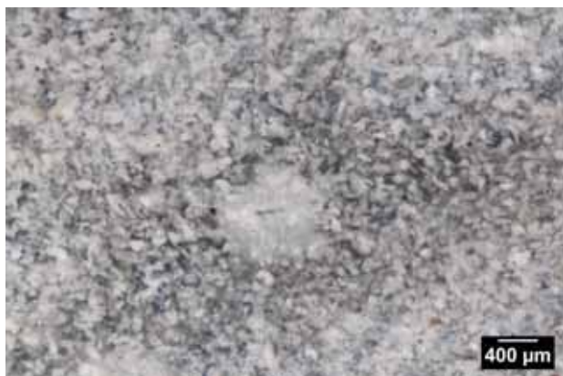
Photo1–Echantillon géologique n°10. Provenance: alluvions de Borde (commune de Saint-Agne, 24). Texture packstone à éléments indéterminés.
