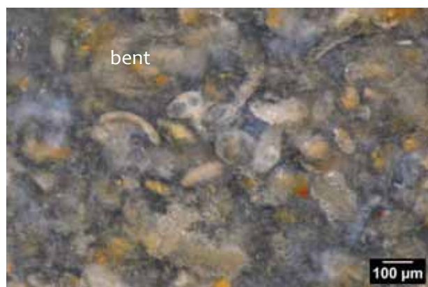
Photo 2 – Echantillon géologique n° 19. Texture packstone à foraminifères benthiques et débris indéterminés.
