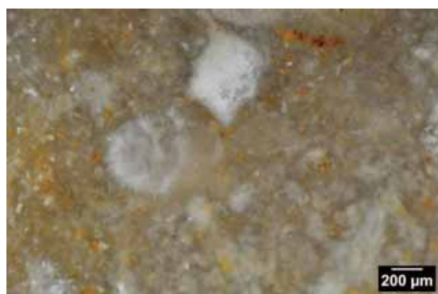
Photo 6 – Echantillon géologique n° 29-47-1, texture wackestone à débris indéterminé.
