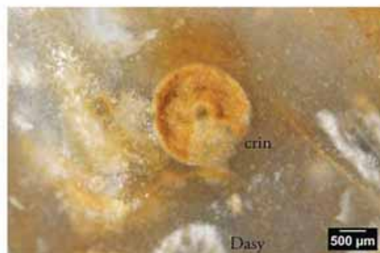
6 : texture wackestone à fragments de crinoïde et Dasycladacées, échelle 500 µm.
