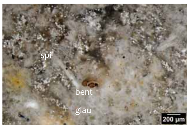
Photo 6 – Echantillon géologique n° 15, texture wackestone à spicules, foraminifère benthique et glauconie.
