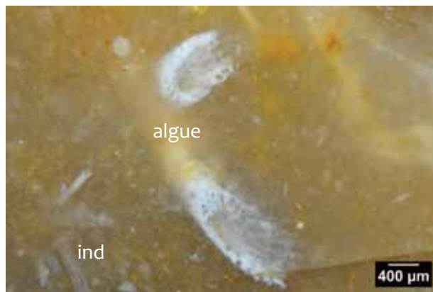
Photo 2 – Echantillon géologique HS7, texture wackestone à fragments d'algues et élément indéterminé.
