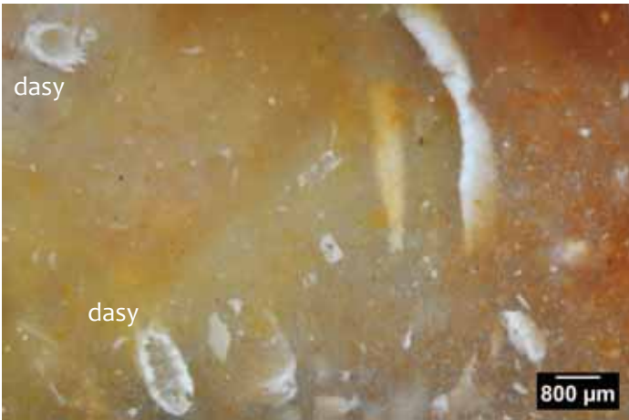
Photo 1 – Echantillon géologique n° 29-47-1, texture wackestone à dasycladacées ( Cylindroporella et Neomeris ).
