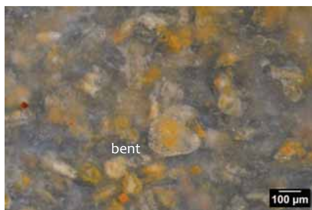
Photo 6 – Echantillon géologique n° 19. Texture packstone à foraminifère benthique et éléments indéterminés.
