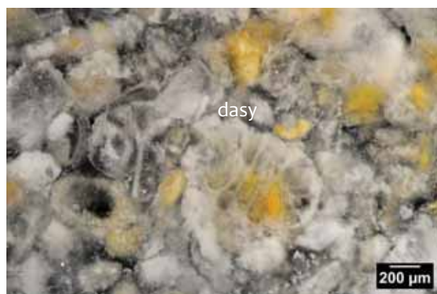
Photo 2 – Echantillon géologique n° 8, texture packstone à dasycladacée.
