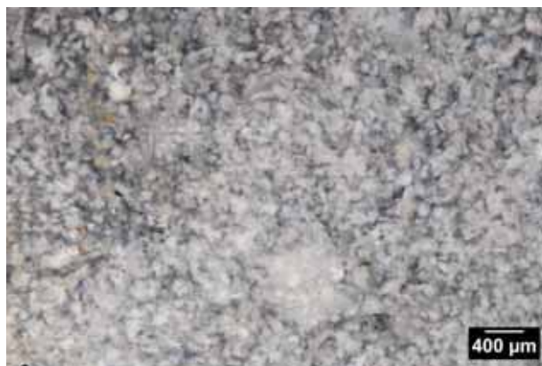
Photo2–Echantillon géologique n°10. Provenance: alluvions de Borde (commune de Saint-Agne, 24). Texture packstone à éléments indéterminés, on note l'absence d'oxyde de fer.
