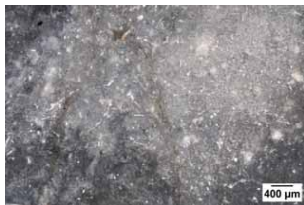
Photo 2 – Echantillon géologique n° 24-2, texture wackestone à foraminifères benthiques et spicules.
