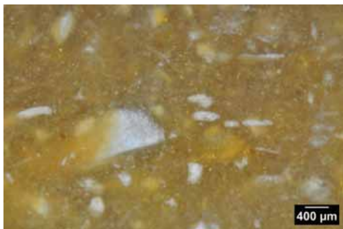
Photo 2 – Echantillon géologique, secteur 1, texture wackestone à débris indéterminé.
