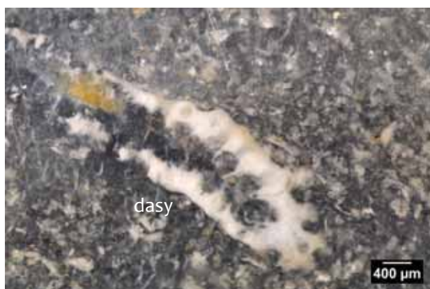
Photo 1 – Echantillon géologique n° 1, texture packstone à dasycladacée.
