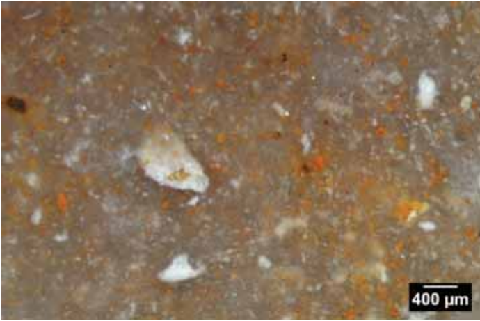
Photo 2 – Echantillon géologique n° 29-47-1, texture wackestone à algues et débris indéterminé.
