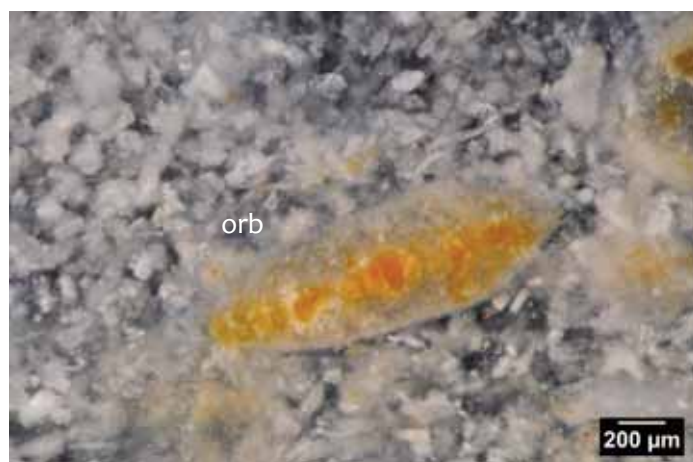
Photo 1 – Echantillon géologique n° 5, texture packstone à orbitoïde.
