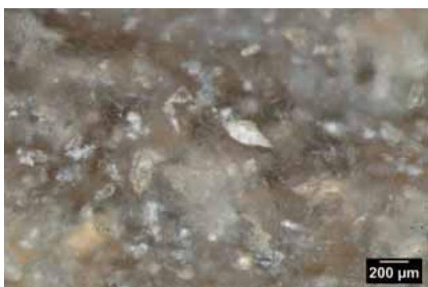
Photo 5 – Echantillon géologique, Belvès 2, texture wackestone à débris indéterminés.
