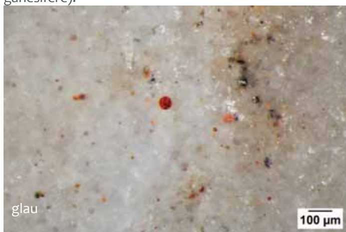
Photo 3 – Echantillon géologique n° 13, texture mudstone à débris oxydés et glauconie.
