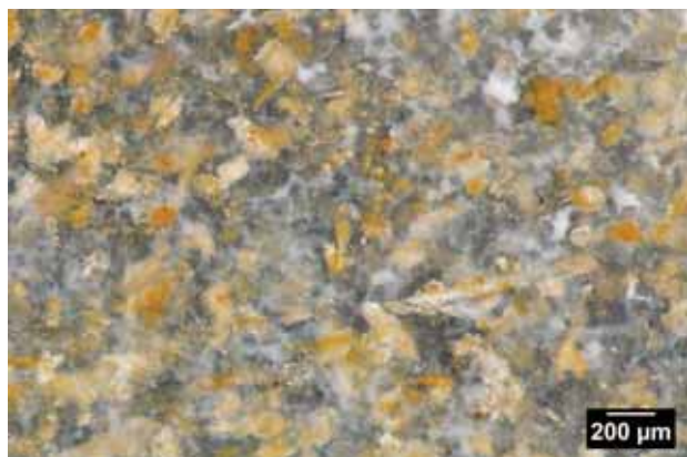
Photo 1 – Echantillon géologique n° 19. Texture packstone à éléments indéterminés.
