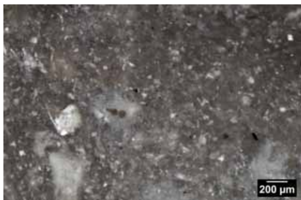
Photo 3 – Echantillon géologique n° C6, texture wackestone à foraminifères benthiques indéterminés.
