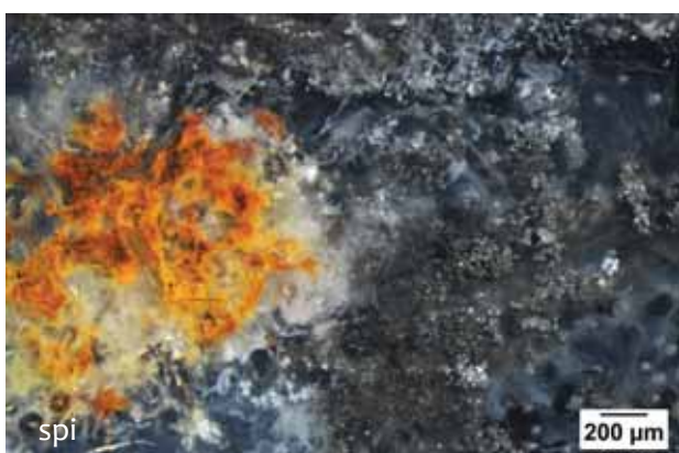
Photo 5 – Echantillon géologique n° 12, texture packstone très riche en spicules à imprégnation d'origine indéterminée (aspect métallique).
