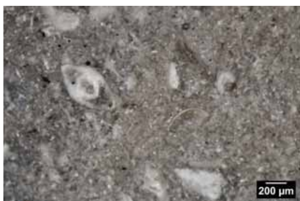
Photo 5 – Echantillon géologique n° C6, texture wackestone à benthiques ( Lenticulina , Lituolida ?).
