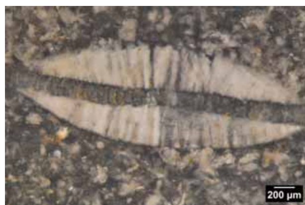
Photo 6 – Echantillon géologique n° 1, texture packstone à orbitoïde.
