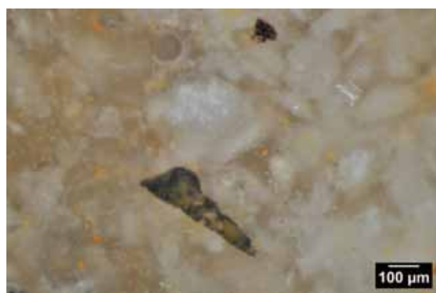
Photo 6 – Echantillon géologique n° 26-47, texture packstone à éléments oxydés indéterminés.
