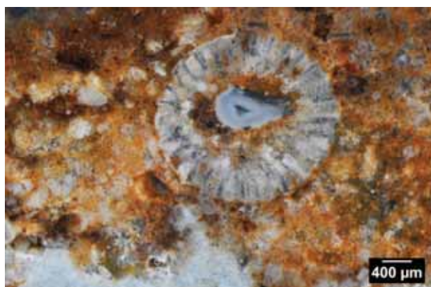
Photo 5 – Echantillon géologique n° 8, texture packstone à section de bryozoaire.
