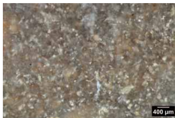
Photo 4 – Echantillon géologique, Belvès 2, texture wackestone à débris indéterminés.
