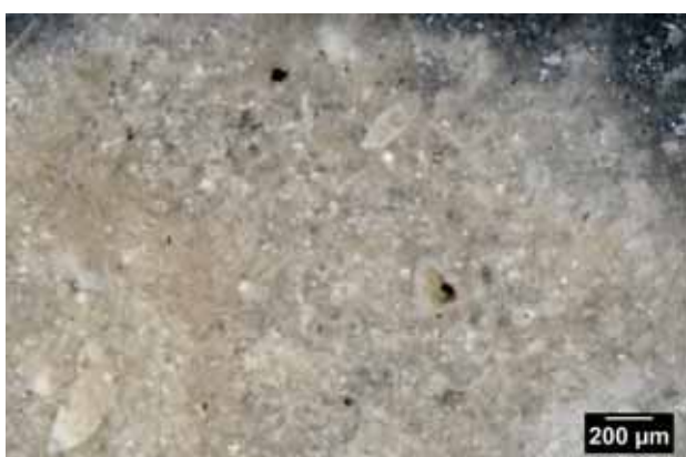
Photo 5 – Echantillon géologique n° 24-2, texture wackestone à foraminifères indéterminés.
