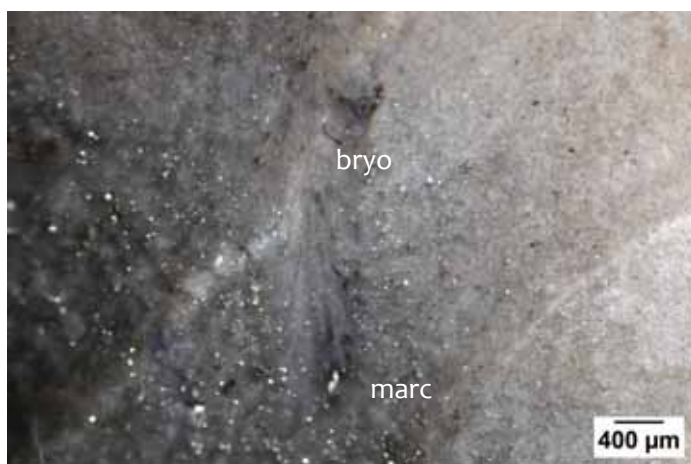
Photo 3 – Echantillon géologique n° bloc 3, texture mudstone à bryzoaire et formes d'aspect métallique (pyrite ou marcassite ?). Milieu réducteur à sulfure riche en organique.
