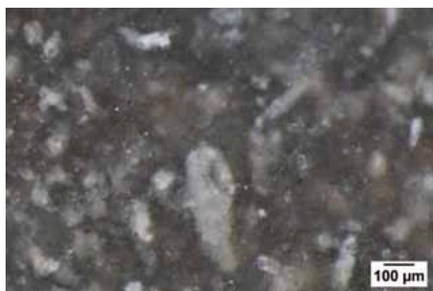
Photo 3 – Echantillon géologique, Belvès 1, texture wackestone à débris indéterminés.
