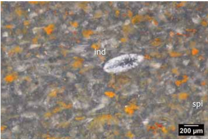
Photo 3 – Echantillon géologique n° 24-B, texture wackestone à spicules et élément indéterminé.
