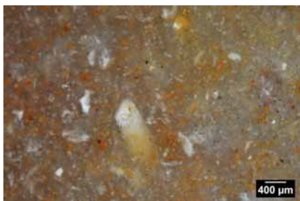
Photo 1 – Echantillon géologique n° 29-47-1, texture wackestone à débris indéterminé.
