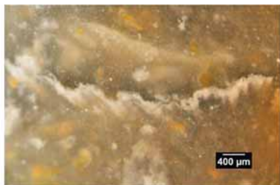
1 : texture wackestone à fragment de bivalve, échelle 400 µm.
