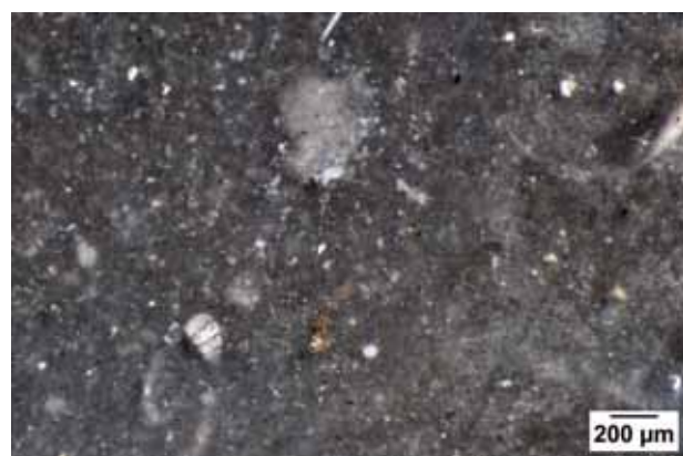
Photo 4 – Echantillon géologique n° 24-2, texture wackestone à foraminifères benthique, spicules et éléments d'aspect métallique d'origine indéterminée.
