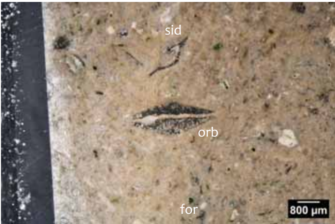
Photo 1 – Echantillon géologique n° 2, texture wackestone à orbitoïde et foraminifères benthiques (sidérolite, orbitoïde).
