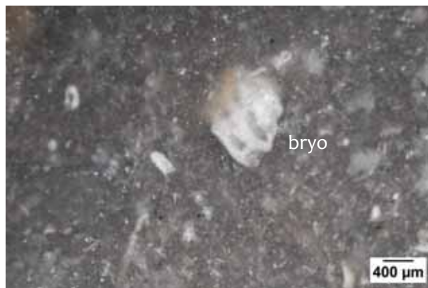
Photo 2 – Echantillon géologique n° C6, texture wackestone à débris indéterminés (bryozoaire?).
