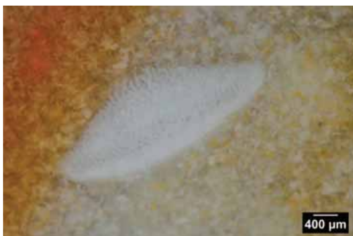
Photo 1 – Echantillon géologique HS2, texture wackestone à orbitoïde.
