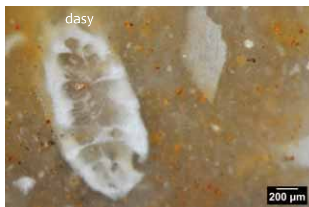
Photo 4 – Echantillon géologique n° 29-47-1, texture wackestone à dasycladacée.
