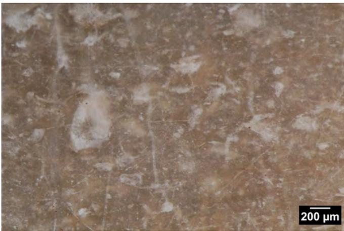
Figure 1 : échantillon géologique, n° 492-165, combe des Naysses, (commune d'Orgnac). Texture *wackestone* à tiges et filaments.
