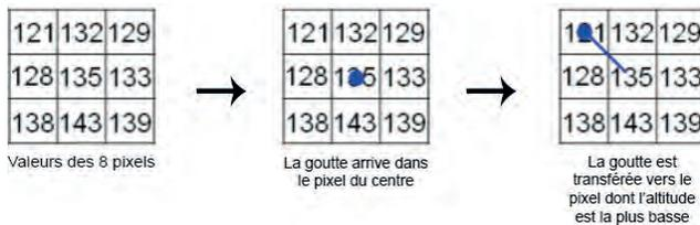
**Figure 236.3 : Principes du calcul dans NetLogo.**
