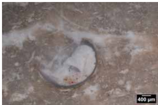
Photo 1 – Échantillon 163, texture wackestone à débris de gastropodes.
