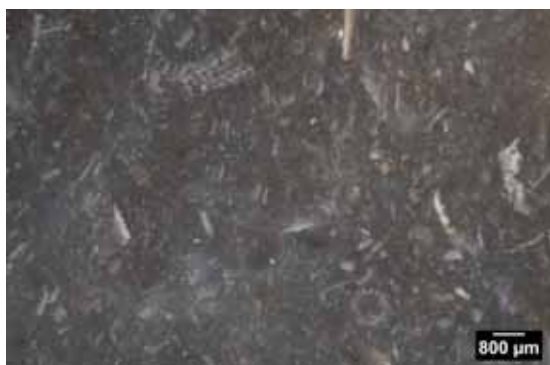
Photo 3 – Échantillon 212, texture wackestone à débris de characées.
