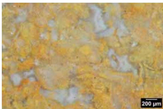
Photo 4 – Échantillon 332-1, porosité inter-bioclastique envahit par la patine blanche.
