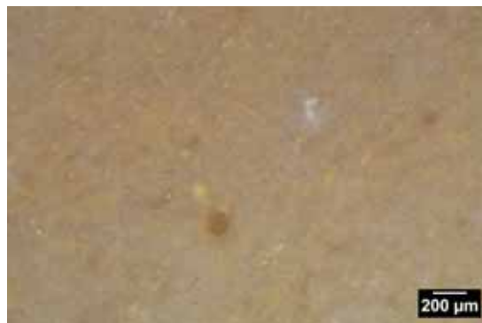
Photo 2 – Échantillon 338-1, texture mudstone à éléments à section de spicules.
