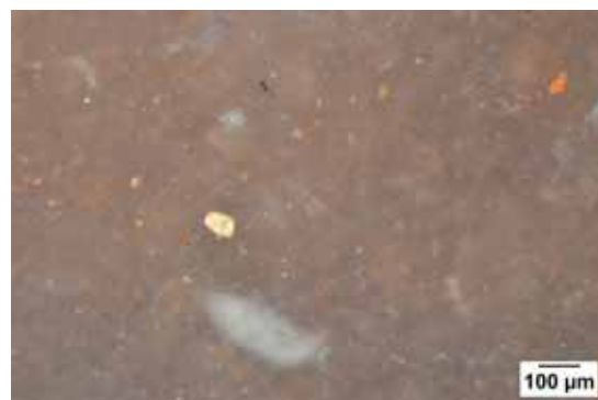
Photo 6 – Échantillon B20a, présence de quartz détritique de 50 µm.
