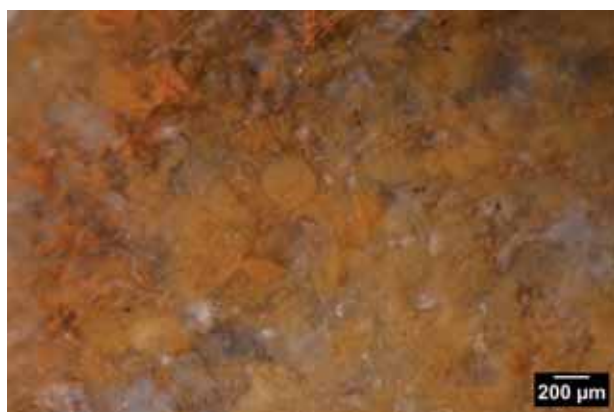
Figure 3 : Objet archéologique, n° G8-J2-22. Texture packstone à débris indéterminés.
