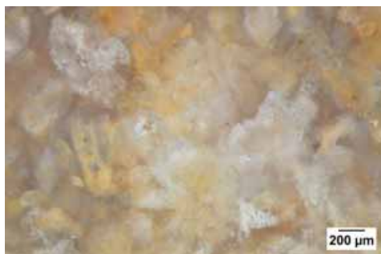
Photo 5 – Échantillon D2-39, clastes épigénisés par le quartz et foraminifère.
