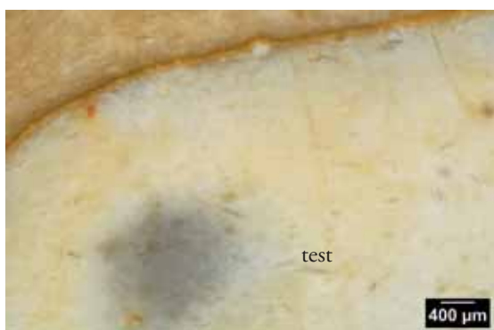
Figure 3 : échantillon géologique, Cassagnole. Texture wackestone à fragments de tests.
