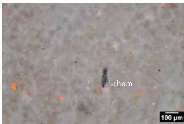
Photo 4 – Échantillon archéologique n° F12-20115, texture mudstone à rhomboèdres et débris fibreux noir.
