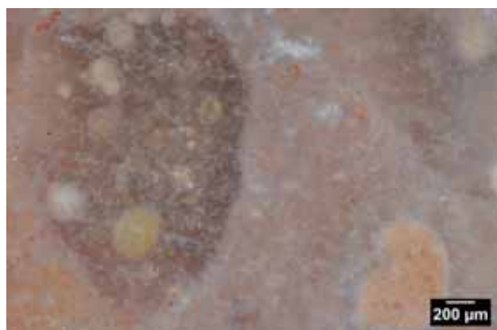
Photo 3 – Échantillon 173, texture wackestone à pseudoolithes dans lumps.
