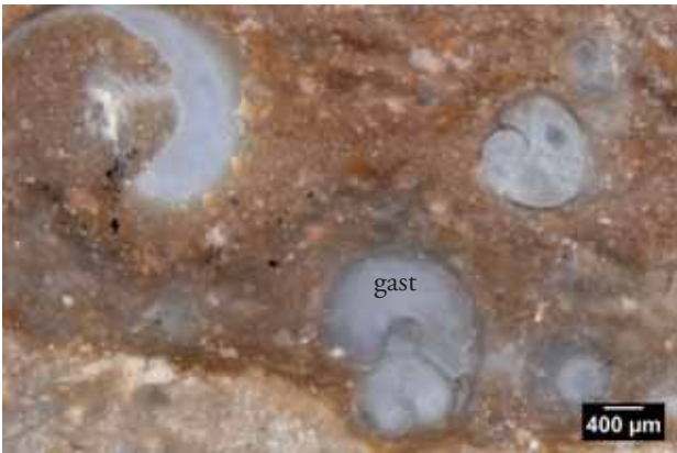
Figure 1 : échantillon géologique, n° 492-2, Combe des Naysses (commune d’Orgnac). Texture packstone à gastropes.
