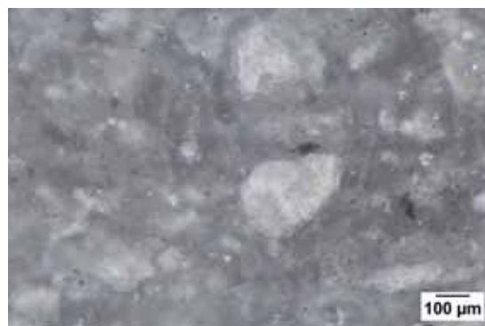
Photo 6 – Échantillon 478-2, texture packstone, absence d'oxyde de fer.
