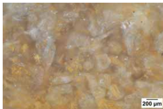
Photo 4 – Échantillon 477-1, texture packstone à clastes épigénisés en quartz et foraminifères.
