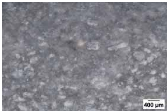
Photo 1 – Échantillon 478-2, texture packstone, absence d'oxyde de fer.
