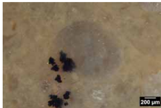
Photo 2 – Échantillon 337-14, à section de gastéropode et dendrites.
