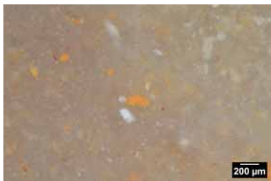
Photo 1 – Échantillon B12c, texture wackestone à clastes indéterminés et foraminifères.
